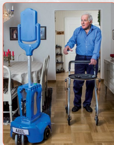
El robot GiraffPlus está diseñado para controlar las constantes de los ancianos.
